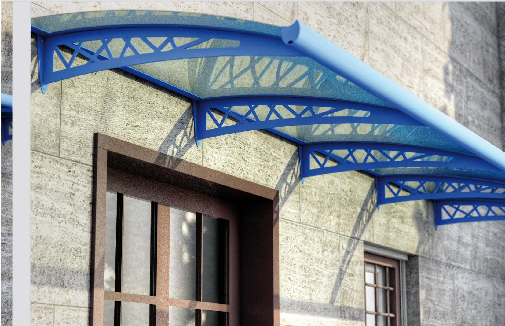
Bracci in acciaio zincato e verniciato come da ns. cartella colori, sp.4 mm con adeguate alette per il deflusso delle acque, con avente misura di sporgenza di 750/1000/1250/1500 mm. possibilita' di aumentare la larghezza del prodotto con misure multiple di quelle standard (vedi ns. listino).
